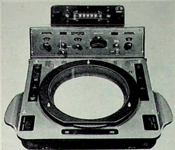
Die Bedienelemente für die Relativbewegungsmarken der Decca-Transar-Anlage „66 AC“ sind über dem Bedienfeld für das Manöverradar angeordnet. Außer den Schaltern für die fünf Markierungslinien gibt es Bereichsschalter und -anzeige sowie Helligkeitsregler und einen Knopf für den Peilwinkel der Markierung
