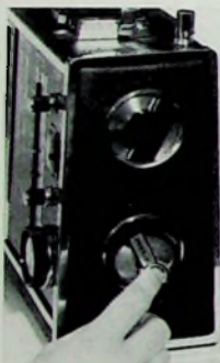
Bild 12 (links). Die Abstimmung des Kurzwellen-Trommeltuners im „Satellit“ von Grundig läßt sich mit dem Finger bequem durchkurbeln. Bild 13 (rechts). „Satellit“ von Grundig mit bedienungsgerecht davor angebrachtem SSB-Zusatzteil
