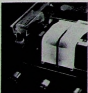
Bild 19. Der Leuchtbandscheider des „stereo 3000“ ist aus gut lichtleitendem Material gefertigt. Zur Ausleuchtung führt er oberhalb ein Skalenscheider mit. Die Seitenflächen des Scheiders sind abgedeckt, damit eine scharfe Begrenzung erfolgt
